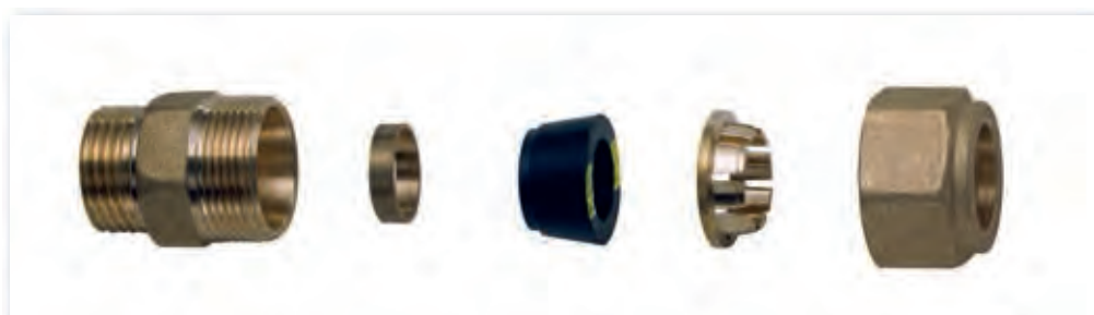
Корпус фитинга из штампованной латуни Направляющее кольцо для медной трубы \varnothing 10 - 12 - 14 Конусообразное уплотнение Переходник для фиксации медной трубы Накладная гайка
